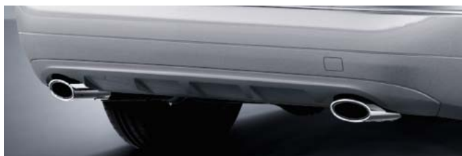
6 cilindros em V: saia traseira com elemento difusor, guarnições para duas saídas de escape ovalados
