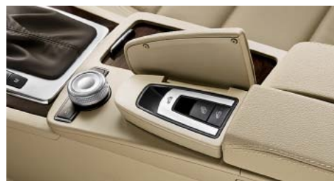
Unidade de comando para acionamento da capota no console do câmbio
